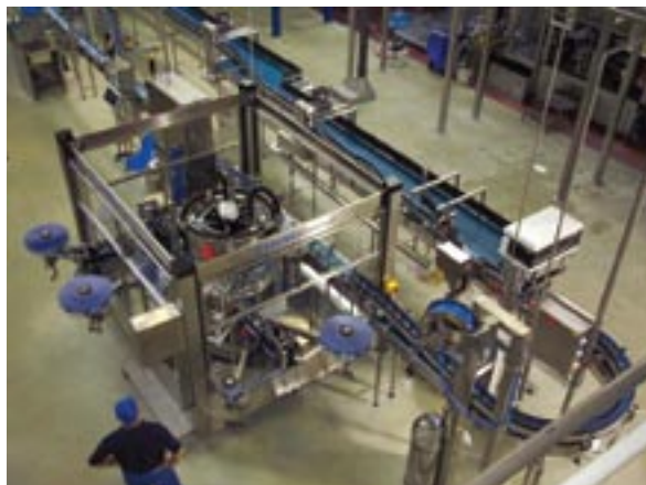
A sopradora Contiform S12 em operação na planta da Femsa
