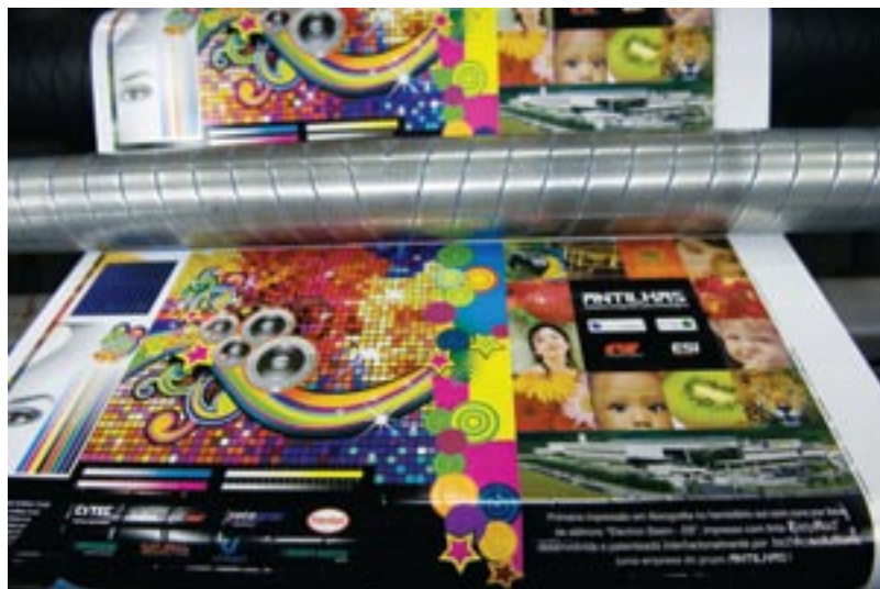
Acima, a primeira impressão da Antilhas com o electron beam. Tecnologia foi instalada numa máquina Comexi oito cores (abaixo)
