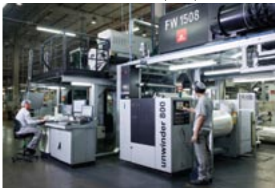
Acima, a primeira impressão da Antilhas com o electron beam. Tecnologia foi instalada numa máquina Comexi oito cores (abaixo)
