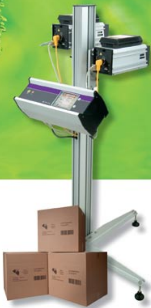
5800 , codificador a jato de tinta de grandes caracteres em alta resolução
